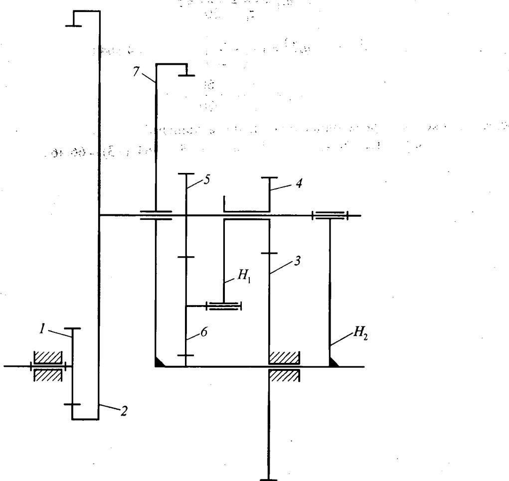
Определить передаточное отношение механизма  $u_{1H_2}$ , если известны числа зубьев  $z_1 = 20$ ,  $z_2 = 100$ ,  $z_3 = 60$ ,  $z_5 = 22$ ,  $z_6 = 26$ .
