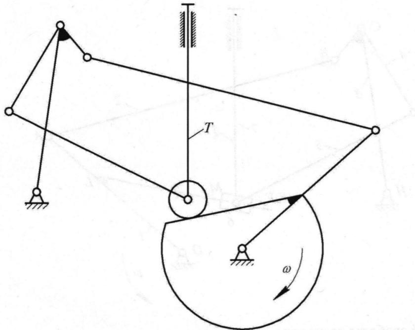
На рисунке изображена структурная схема механизма перемещения крышки вулканизатора.
