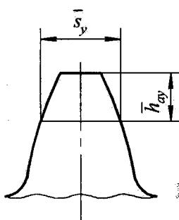
Эвольвентное зубчатое колесо нарезается стандартным инструментом со следующими параметрами: модуль  $m = 10 \text{ мм}$ , угол профиля исходного производящего контура  $\alpha = 20^\circ$ , число зубьев  $z = 40$ , диаметр окружности вершин  $d_a = 420 \text{ мм}$ .
