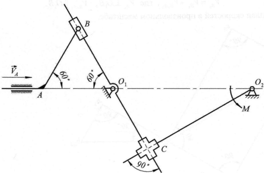
О механизме с крестовиной известно следующее: скорость точки  $A$   $v_A = 1 \text{ м/с}$ , длина звена  $AB$   $l_{AB} = 0,1 \text{ м}$ , расстояние между опорами  $l_{O_1O_2} = 0,2 \text{ м}$ , крутящий момент на валу  $O_2$   $M = 10 \text{ Н}\cdot\text{м}$ .
