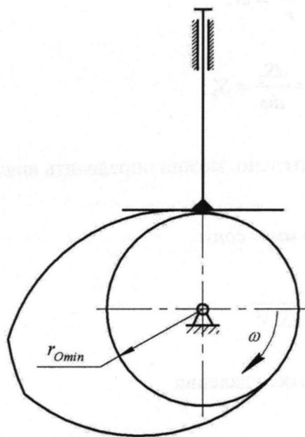
Ход толкателя кулачкового механизма на угле удаления  $\varphi_y = 180^\circ$  составляет  $H = 40$  мм. Минимальный радиус кулачка  $r_{O\min} = 40$  мм. Закон движения толкателя  $S = a\varphi$ . Угловая скорость кулачка  $\omega = \text{const}$ .
